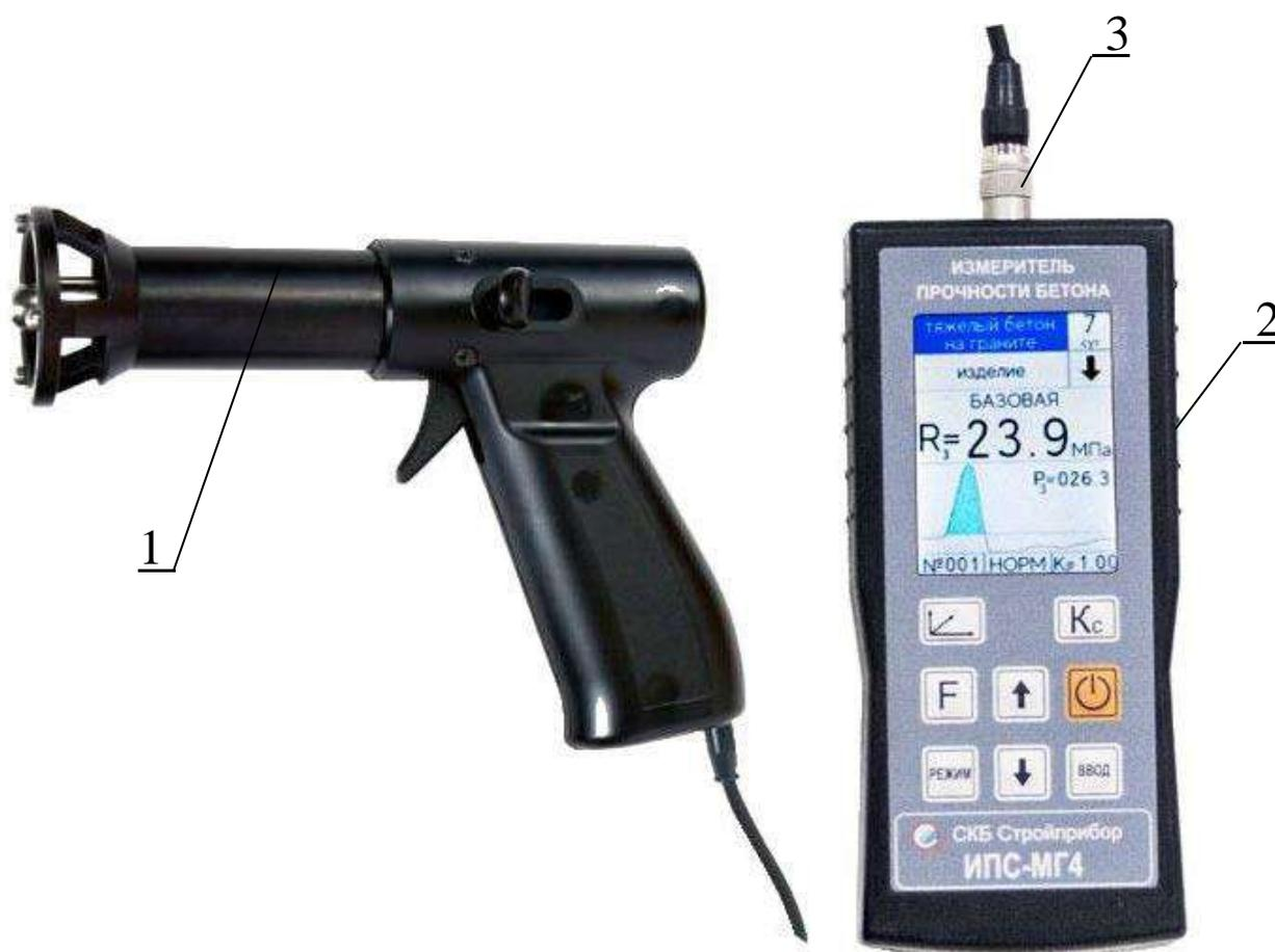
1 – преобразователь 2 – электронный блок
