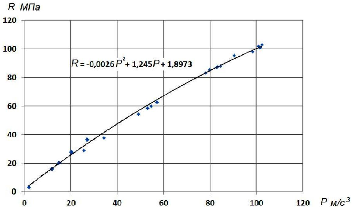
Рисунок 2 - Построение градуировочной зависимости между параметром  $P$  и прочностью бетона  $R$  с помощью полинома второго порядка:  $a_2 = -0,0026$  (2,6E-3);  $a_1 = 1,245$ ;  $a_0 = 1,897$
