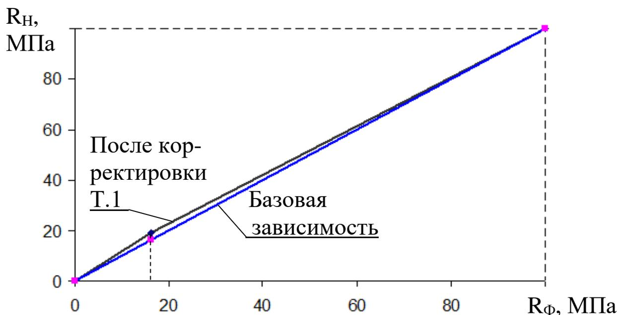
где  $R_n$  – средняя прочность бетона по показаниям измерителя, МПа;
