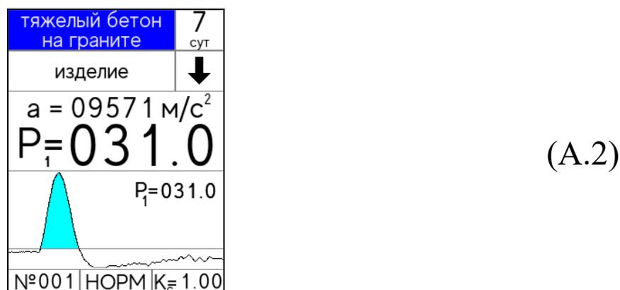
Для отображения параметров ударного импульса можно в процессе измерения прочности бетона нажать клавишу «↓».
